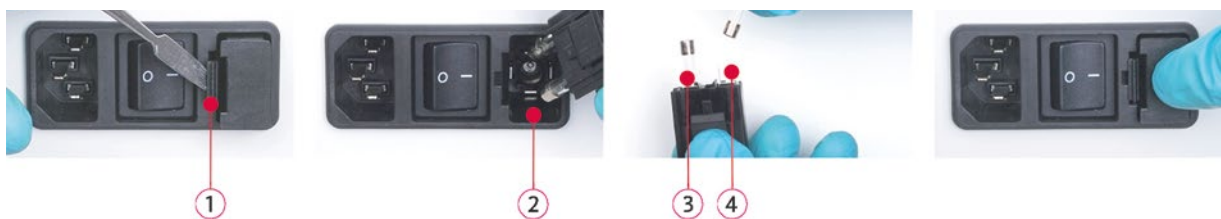
1 Afsluiting van het zekeringsvakje 2 Raampje voor ingestelde spanning 3 Zekeringsvakje 4 Zekering 1 5 Zekering 2
